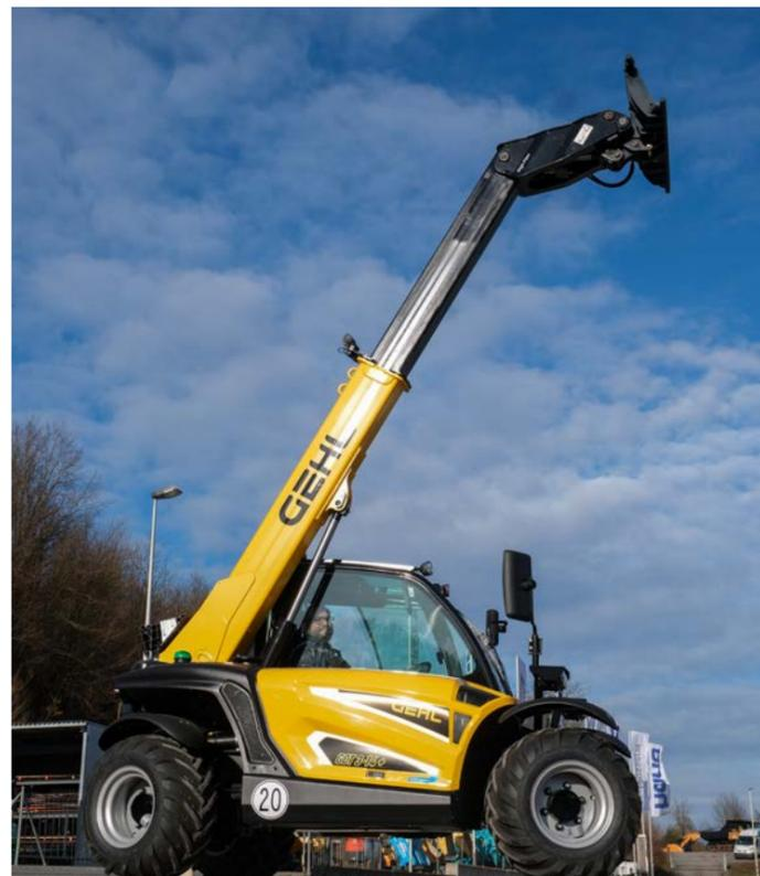
Wir zeigen an der Öga den **Teleskopklader Gehl GCT 3-14+** als **Europaneuheit**. Die Maschine wurde entwickelt, um Zeit und Geld zu sparen. Mit einer Tragfähigkeit von 1,5 Tonnen kann der GCT problemlos Paletten mit Betonblöcken oder Ziegeln, Strohballen oder Heu transportieren.
