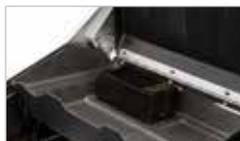
5 Batterieladegerät für Fernbedienung (24 V DC, 100-240 V AC)
