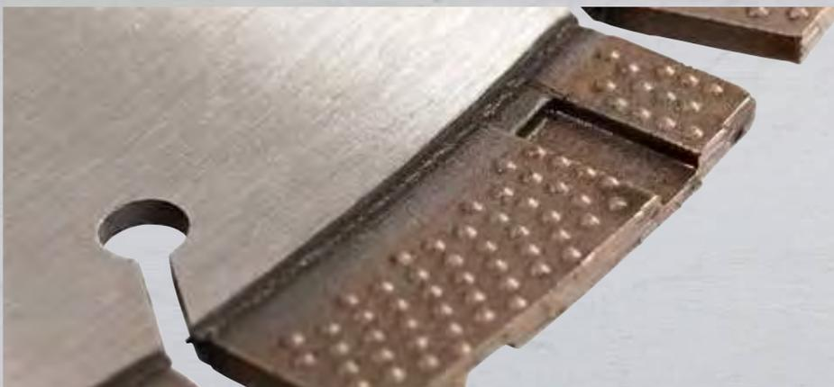
**NEU EXO-GRIT** Das neue Elite-Cut S35, S45 und S65 Trennscheiben ist mit dem EXO-GRIT Diamantsegment ausgestattet. Dieses neue Design verringert die seitliche Reibung, verbessert die Schnittgeschwindigkeit und Glätte sowie eine bessere Kühlung und verbesserte Staubabsaugung. Diese wird im 1. Quartal 2021 das bestehende Sortiment ersetzen.
