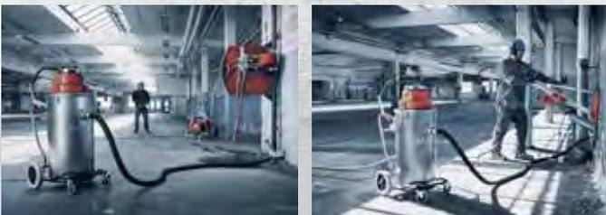
Bei nassen Trenn-/Bohrverfahren wird der Staub direkt am Entstehungsort mit Wasser gebunden. Die Vorrichtung zum Aufsammeln des Schlamms kann an einen Schlammsauger angeschlossen werden, um den Arbeitsplatz sauber zu halten.
