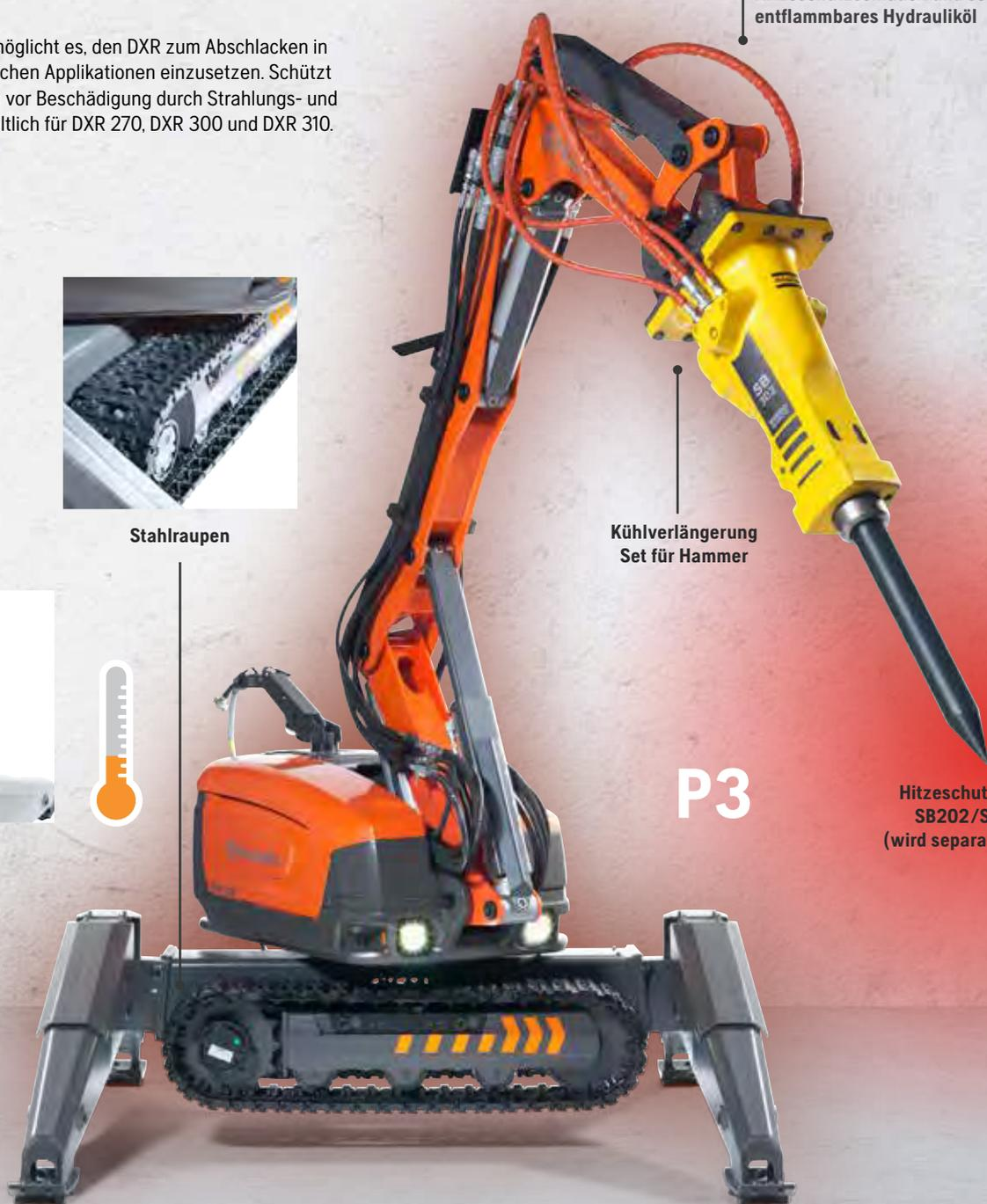
Hitzeschutzschlauch und schwer entflammables Hydrauliköl
