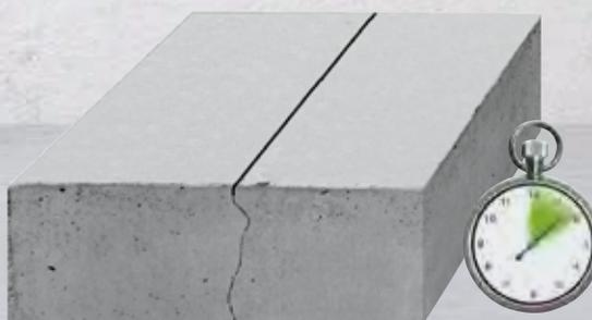
Soff-Cut ist mit dem Ultra Early Entry™ Trockenschneidsystem ausgestattet, mit dem das Auftreten von Spannungsrissen durch frühzeitiges Schneiden verhindert wird.
