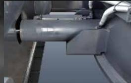
**Schutz für den Aus-/Einfahr-Mechanismus des Kettenfahrwerks (nur SK400DLC)**
