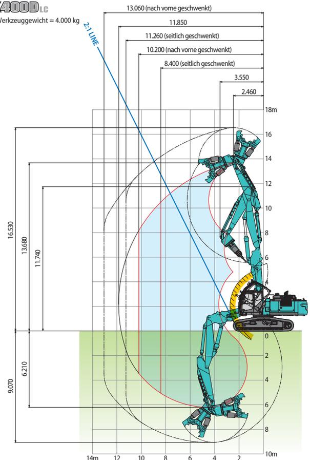
Arbeitsbereich mit Kabinen-Kollisionsschutzsystem
