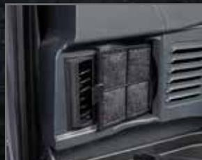
Klimaanlagenfilter für Innenluftzirkulation
