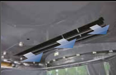
Der versetzte Abgasführung verlangsamt die Abgase des Schalldämpfers und des Motorlüfters.
