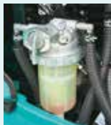
Kraftstoffvorfilter mit eingebautem Wasserabscheider
