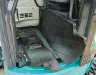
Zweiteilige Bodenmatte für einfache Reinigung
